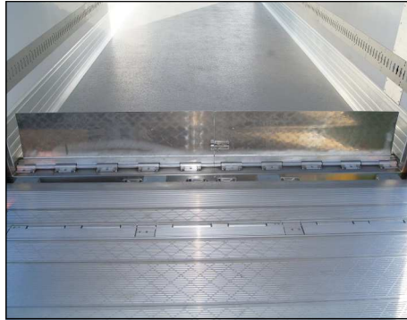
Durchladesystem mit Rampenladen
