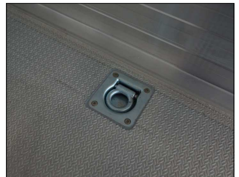
Ladungssicherung im Boden
