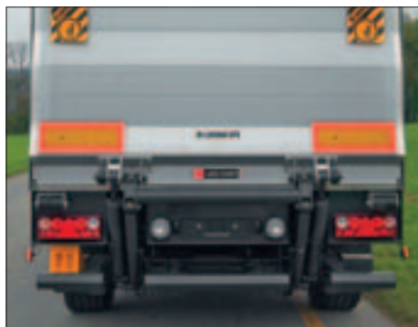
Heck mit vertieftem Abschlussprofil für den Anbau einer Hebebühne
