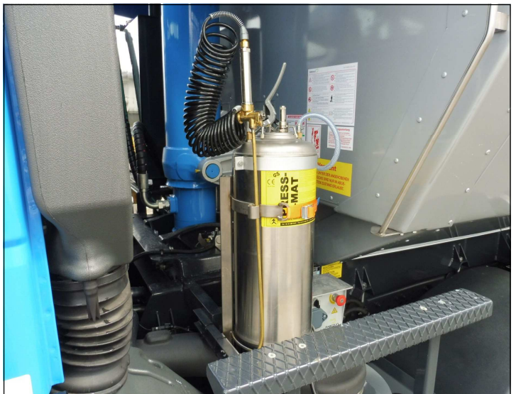
Press-O-Mat mit Spiralschlauch und Lanze
