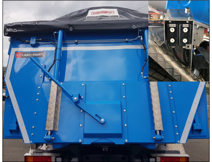
Hydraulisch betätigter und Handschieber im Rückladen
