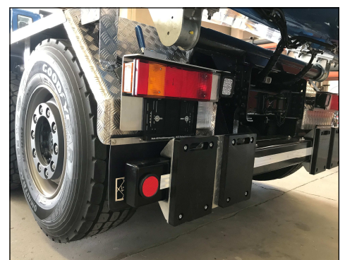
Pneumatischer Unterfahrerschutz mit Schiebepplatten, Fertigttauglich
